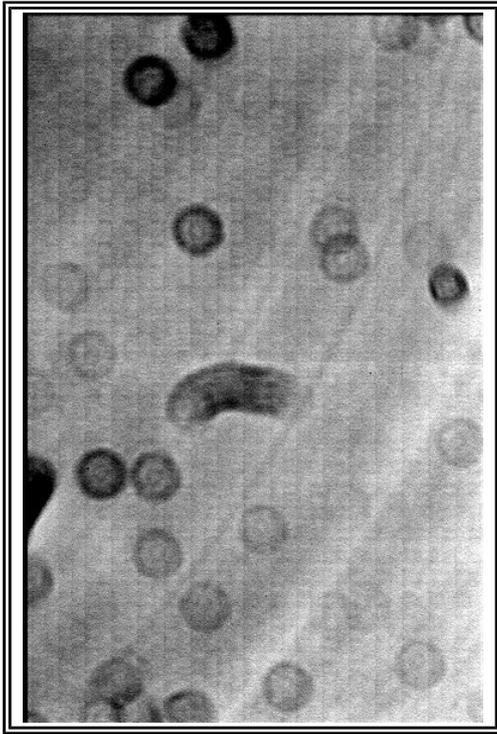
Imagen 2.3. "Flat-field" resultante de la combinación de 10 *flat-fields*, sin filtro, en ganancia 4 y con exposiciones entre 1.5 y 6 seg. El patrón de franjas en forma de arcos circulares constituye la cosmética del CCD. Los círculos oscuros son producidos por partículas de polvo depositadas sobre la ventana del chip.
